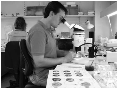
Foto: opvallend-lichtmicroscoop met vergroting tot 50x, een lichtbron met koud licht en flexibele lichtpunten, voor analyse van botanische macroresten
